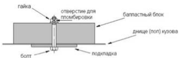
**Максимальный вес на одно крепление 50кг болты крепления должны быть минимальным диаметром 14 мм.**
