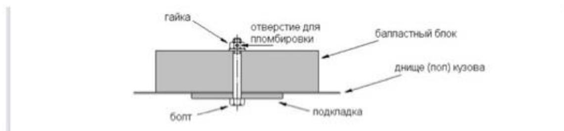
**Максимальный вес на одно крепление 50кг болты крепления должны быть минимальным диаметром 14 мм.**
